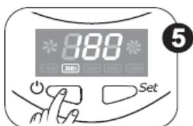
5. Нажмите кнопку Пуск для запуска процесса очищения. Загорится голубая лампочка, затем таймер начнет отсчитывать время назад до нуля.
